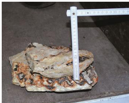
Ablagerungen, die bei einem Projekt in der Gärtnerstraße in Hamburg-Eimsbüttel mit Höchstdruckwasserstrahlen aus dem Kanal entfernt wurden (2013) | Foto: Mauerspecht
