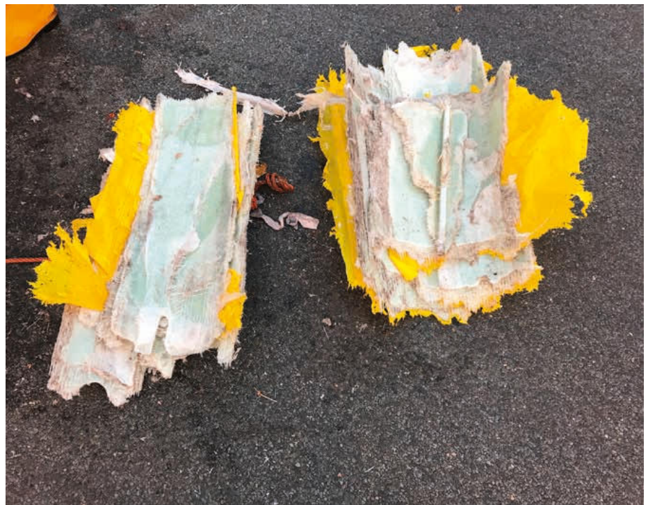
Bild 6: Mit dem Höchstdruck-Wasserstrahl entfernte Linerstücke
