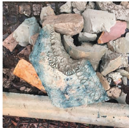
1.200 bar pure Wasserkraft: Die Kringel im Beton zeigen eindrucksvoll die Schärfe des Höchstdruck-Wasserstrahlstrahls.
